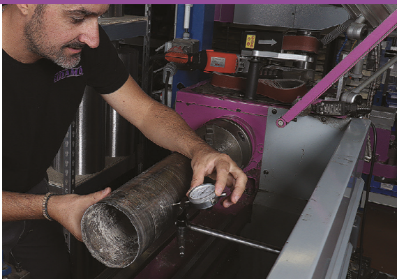
Contrôle de la concentricité : Préparation de la couronne, contrôle et nettoyage
