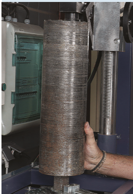
Encochage : Perte de longueur de fût d'environ 3 cm
