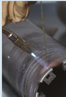
Brasage : Brasage des segments à l'aide d'aimants de maintien
